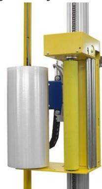
Za proizvode raznih veličina i vrsta, postoji opcija sa nosačem **CA6** sa jednim motorom I fiksni prednatezanjem 150, 200 ili 250% i sa nosačem **CA7** sa dva motora i prednatezanjem od 120 do 350% (1 metar postaje 4,5 metra folije).
